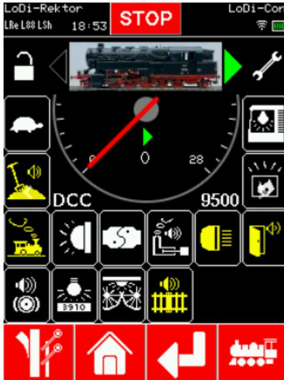
Sie haben jetzt die Lok komplett angelegt und können über den Fahrregler die Lok steuern und die Funktionen über das Touchdisplay abrufen. Sollte die Lok mehr Funktionen haben, können Sie diese durch **Wischen nach unten** im Lokscreen erreichen.
