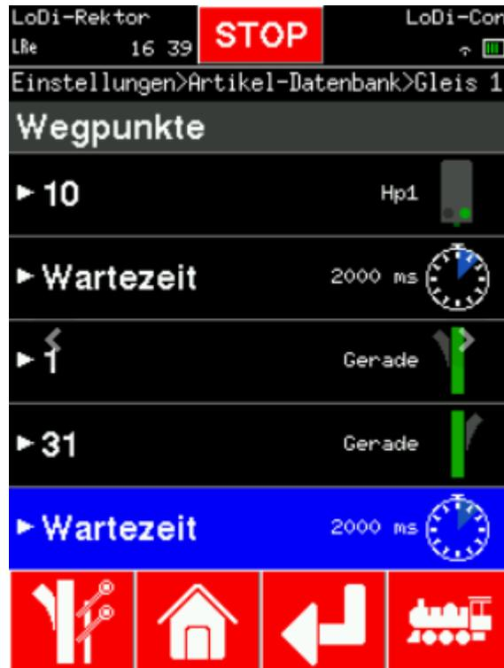
Wir starten nun mit einem Signal, wählen Sie es aus und setzen den Zielzustand für dieses Signal.
