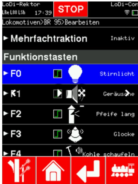
Das LoDi-Con kann bis zu 68 Lokfunktionen + Licht abrufen. All diese Funktionen können mit Piktogrammen ausgestattet und zugeordnet werden. Um diese nun zu ändern, scrollen Sie in den Lokeigenschaften bis sie zu dem Punkt "Funktionstasten" kommen.
