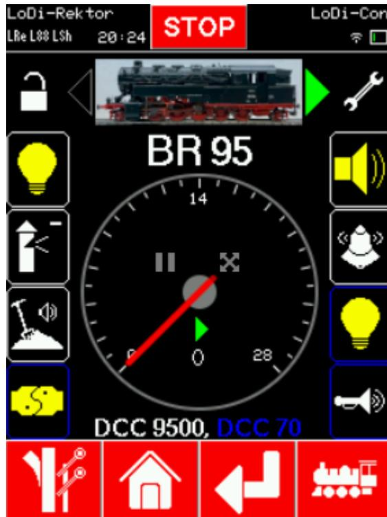
Wenn Sie jetzt wieder in die Lokübersicht zurück wechseln, wird unten in der Leiste eine weitere DCC-Adresse in einer anderen Farbe angezeigt. Dies ist die zweite Lok im Verbund. Auch werden die Lokfunktionen der angehängten Lok mit einer blauen Umrandung angezeigt.
