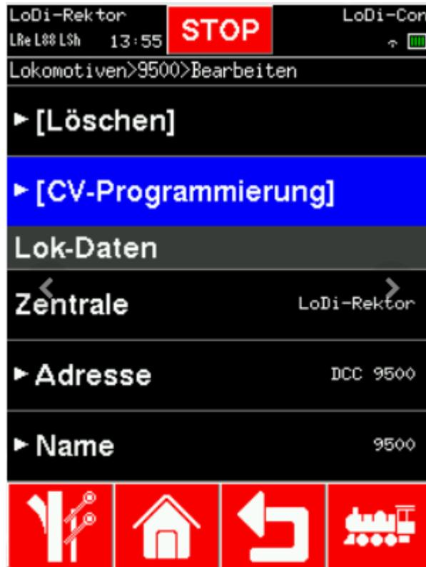
Um nun eine CV zu programmieren, gehen Sie zunächst in die Lokomotive, bei der Sie die CV ändern möchten.
