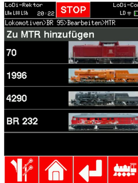
Sie gelangen nun in das Menü, in dem Sie eine Lok aus der Datenbank in die **Multitraktion** mit einschließen können.
